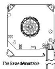
Trappe démontable par-dessous, collée au porteur pour conserver de la rigidité une fois démontée et permettre un remontage plus aisé. Démontage du moteur facilité
