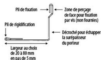
NB : pili de fixation à positionner au-dessus du porteur bas
